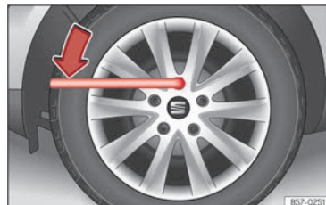
Abb. 187 Radwechsel: Radschrauben lockern.
