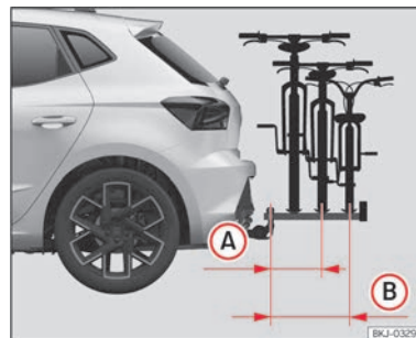
Abb. 145 Schematische Darstellung des maximalen Überstands der Ladung in einem Fahrradträger für zwei oder drei Fahrräder.
