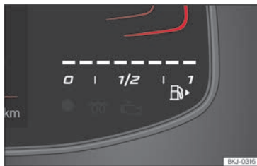
Abb. 3 Kombi-Instrument Basic: Kraftstoffvorratsanzeige.
