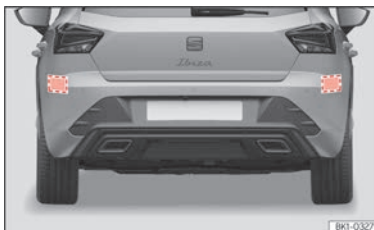
Abb. 98 Bereich hinter dem Fahrzeug: Bereiche der Radarsensoren.
