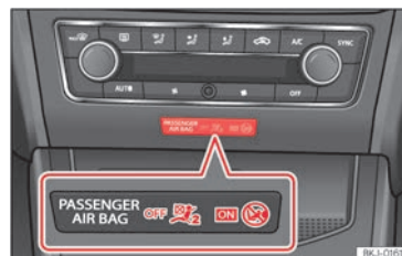
Abb. 29 Schalttafel-Mitte: Kontrollleuchte für abgeschalteten Beifahrerairbag.
