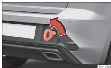
Abb. 159 Auf der rechten Seite des hinteren Stoßfängers: eingeschraubte Abschleppöse.
