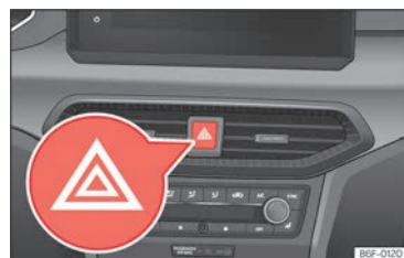
Abb. 42 Schalttafel: Schalter für die Warnblinkanlage
