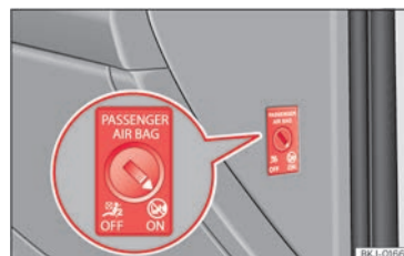
Abb. 28 Schlüsselschalter zum Ein- und Abschalten des Beifahrerairbags.
