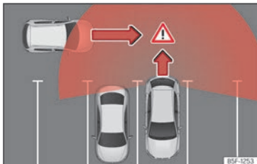
Abb. 125 Schematische Abbildung des Ausparkassistenten: Überwachter Bereich des ausparkenden Fahrzeugs.
