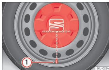
Abb. 183 Korrekte Anbringung der Radvollblende für Stahlfelgen.
