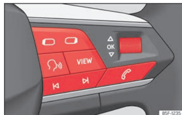
Abb. 11 Rechte Seite des Multifunktionslenkrads: Bedienelemente für die Menüs und Informationsanzeigen im Kombi-Instrument (modellabhängig).
