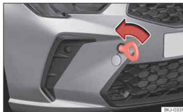
Abb. 157 Vorderer Stoßfänger rechts: eingeschraubte Abschleppöse
