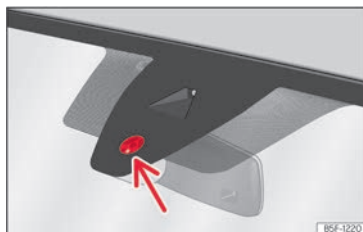
Abb. 77 Sensitive Fläche des Regensensors.
