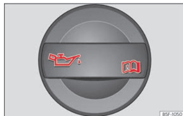
Abb. 177 Deckel der Motoröl-Einfüllöffnung im Motorraum.
