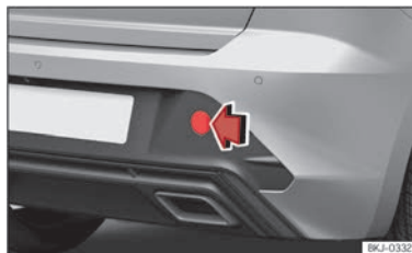
Abb. 158 Auf der rechten Seite des hinteren Stoßfängers: Abdeckung entfernen.
