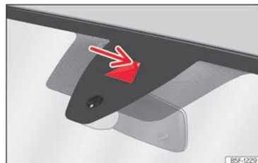
Abb. 97 An der Frontscheibe: Kamerasichtfenster des Spurhalteassistenten.
