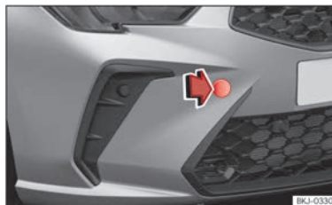
Abb. 156 Auf der rechten Seite des vorderen Stoßfängers: Abdeckung entfernen.
