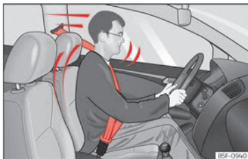
Abb. 18 Richtig angegurte Fahrer werden bei einem plötzlichen Bremsmanöver nicht nach vorne geschleudert.
