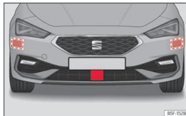
Abb. 127 Im vorderen Stoßfänger: Radarsensoren vorn und seitlich.
