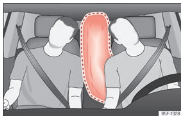
Abb. 31 Vollständig entfalteter Center-Airbag (Entfaltungsbereich)
