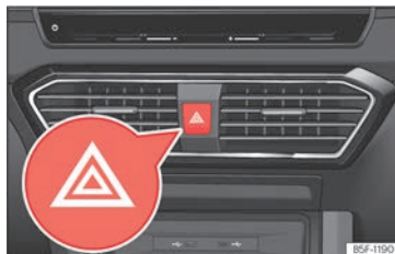
Abb. 48 Schalttafel: Schalter für die Warnblinkanlage
