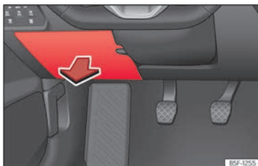
Abb. 235 Auf der Fahrerseite in der Schalttafel: Abdeckung des Sicherungskastens.
