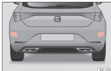
Abb. 130 Bereich hinter dem Fahrzeug: Bereiche der Radarsensoren.
