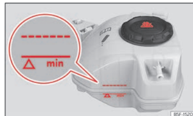
Abb. 242 Im Motorraum: Kühlmittel-Ausgleichsbehälter.
