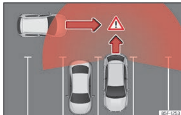
Abb. 170 Schematische Abbildung des Ausparkassistenten: Überwachter Bereich des ausparkenden Fahrzeugs.
