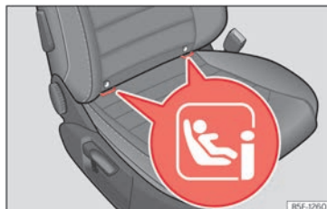
Abb. 41 Beifahrersitz: Einbauort der Halteösen i-Size.
