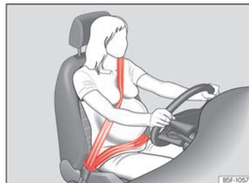
Abb. 25 Gurtbandverlauf bei schwangeren Frauen.
