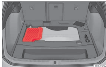
Abb. 251 Plug-in-Hybridfahrzeuge (PHEV): Einbauort der Batterie im Gepäckraum.
