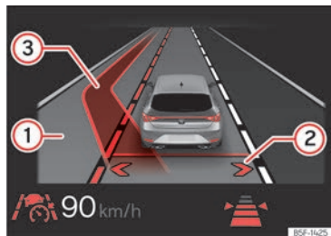
Abb. 147 Im Display des Kombi-Instruments: Anzeige des assistierten Spurwechsels (schematische Darstellung).
