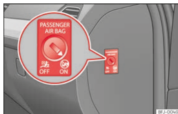
Abb. 28 Schlüsselschalter zum Ein- und Abschalten des Beifahrerairbags.
