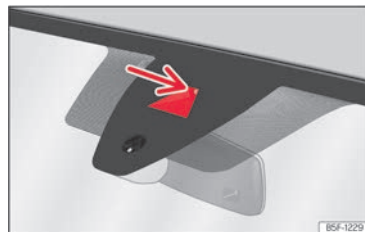
Abb. 129 An der Frontscheibe: Kamerasichtfenster des Spurhalteassistenten.
