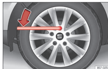
Abb. 262 Radwechsel: Radschrauben lockern.
