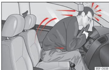
Abb. 20 Der nicht angegurte Fahrer wird nach vorn geschleudert.
