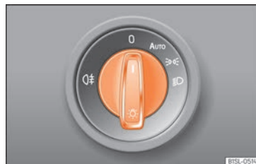
Rys. 110 Z boku kolumny kierownicy: schemat niektórych typów przełącznika świateł
