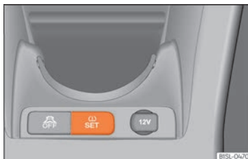
Rys. 189 Konsola środkowa: przycisk systemu kontroli ciśnienia w oponach.
