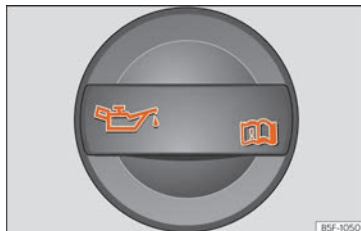
Rys. 182 W komorze silnika: korek wlewu oleju silnikowego.
