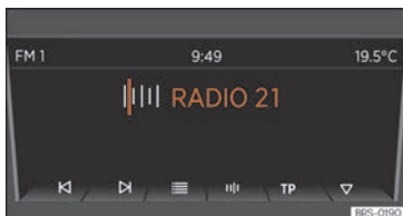
Rys. 147 Przetłoczenie na kolejną dostępną stację przyciskami strzałek.
