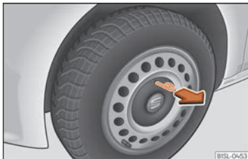
Rys. 51 Zdejmowanie ostony piasty z felgi stalowej
