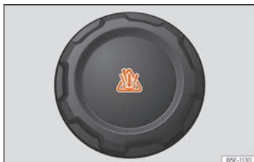
Rys. 184 W komorze silnika: Korek zbiornika wyrównawczego płynu chłodzącego
