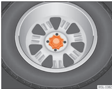
Rys. 190 W bagażniku: nakrętka mocująca koło zapasowe
