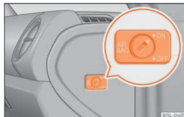
Rys. 21 Po stronie pasażera: przełącznik czołowej poduszki powietrznej pasażera.
