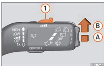
Rys. 115 Dźwignia przełącznika wycieraczek: regulacja czujnika deszczu ①.
