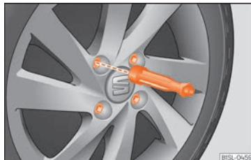
Rys. 58 Zmiana koła: poluzować śruby koła za pomocą końcówki klucza do kół
