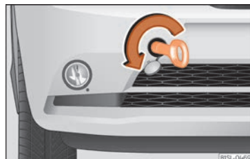
Rys. 82 Z prawej strony zderzaka przedniego: wkręcić pierścień holowniczy.
