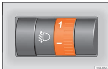
Rys. 112 Obok kolumny kierownicy: Pokrętko regulacji zasięgu reflektorów
