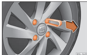
Rys. 53 Zdejmowanie nasadek śrub kół
