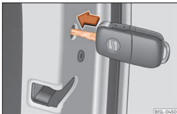
Rys. 6 Awaryjne rygłowanie samochodu za pomocą kluczyka samochodowego
