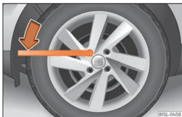
Rys. 54 Zmiana kół: poluzować śruby kół.
