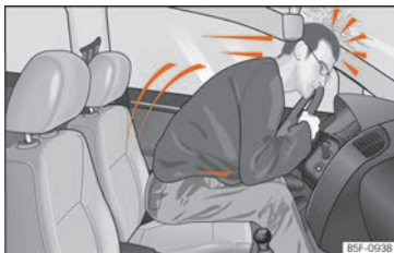
Rys. 71 Kierowca nie posiadający zapiętych pasów bezpieczeństwa zostaje wyrzucony gwałtownie do przodu.
