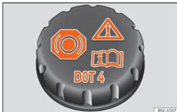
Rys. 44 Komora silnika: korek zbiornika płynu hamulcowego.
