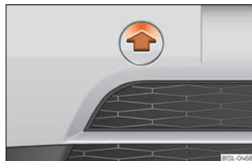
Rys. 81 Z prawej strony zderzaka przedniego: zdjąć zaślepkę.
