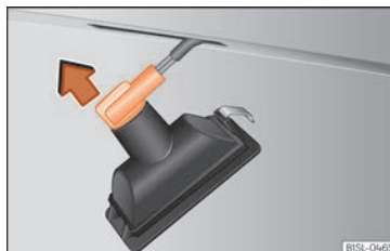
Rys. 92 Lampka tablicy rejestracyjnej: odłączyć oprawkę żarówki.
