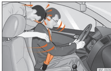
Rys. 72 Pasażer na tylnym siedzeniu nie posiadający zapiętych pasów bezpieczeństwa zostaje gwałtownie wyrzucony do przodu, uderzając kierowcę, który ma zapięty pas.
