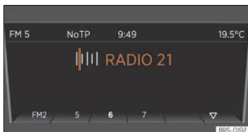
Rys. 148 Przetłoczenie między stacjami przyciskami strzałek działa tylko dla zapisanych stacji.
