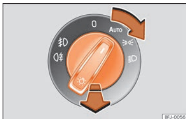
Fig. 43 Plancia portastrumenti: interruttore delle luci.
