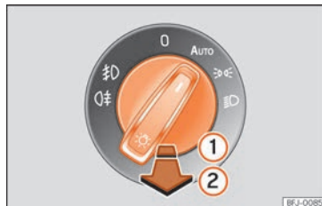
Fig. 132 Plancia portastrumenti: interruttore delle luci.
