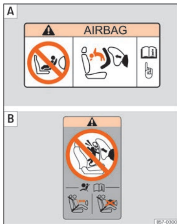
Fig. 35 Adesivi dell'airbag: sull'aletta parasole lato passeggero [A] e nel telaio posteriore della porta del passeggero [B].
