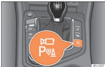
Fig. 292 Console centrale: tasto per attivare/disattivare manualmente il sistema di visione periferica quando è abbinato all'assistente di parcheggio ([A]) o al sistema Park Pilot posteriore ([B]).
