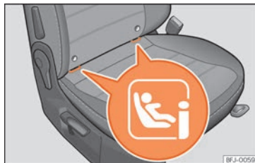
Fig. 38 Sedile anteriore lato passeggero: occhielli di fissaggio del sistema ISOFIX.
