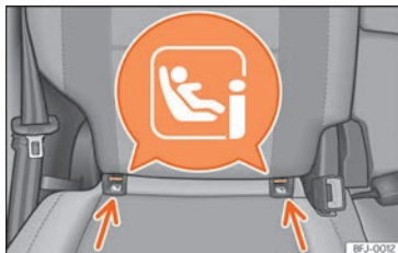
Fig. 37 Sedili laterali della seconda fila: occhielli di fissaggio del sistema ISOFIX/i-Size.
