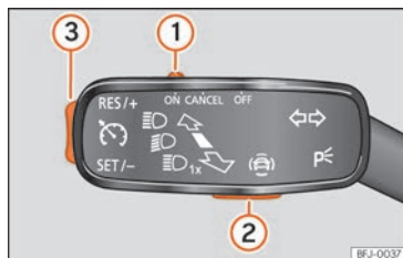
Fig. 255 A sinistra del piantone dello sterzo: comando e tasti per l'uso del regolatore di velocità.
