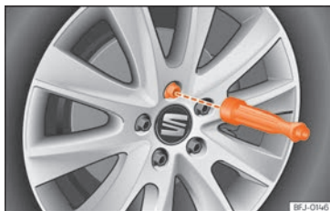
Fig. 78 Ruota: svitare i bulloni della ruota con l'impugnatura del cacciavite.
