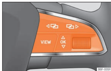
Fig. 114 Lato destro del volante multifunzione: tasti per l'utilizzo dei menu e delle indicazioni informative del quadro strumenti.
