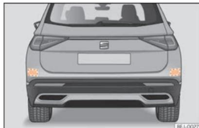
**Fig. 274** Vista posteriore del veicolo: zone dei sensori radar.
