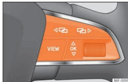
**Fig. 64** Lato destro del volante multifunzione: tasti per l'utilizzo dei menu e delle indicazioni informative del quadro strumenti.
