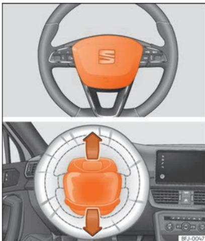
**Fig. 16** Airbag del conducente all'interno del volante.
