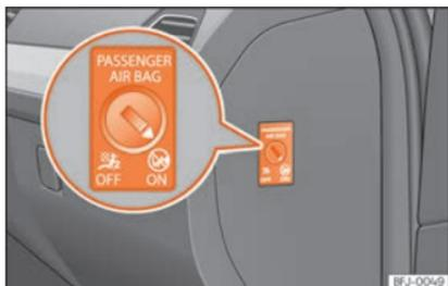
**Fig. 18** Interruttore a chiave per l'attivazione e la disattivazione dell'airbag del passeggero.
