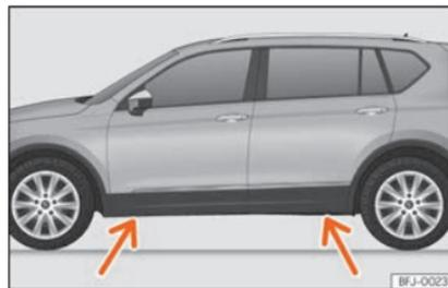
Fig. 40 Punti di appoggio per il cric.
