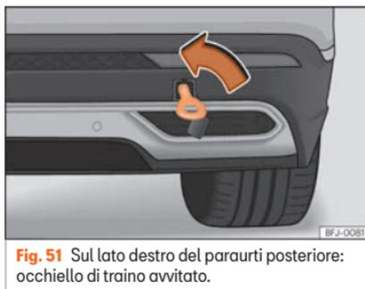
Fig. 51 Sul lato destro del paraurti posteriore: occhiello di traino avvitato.
