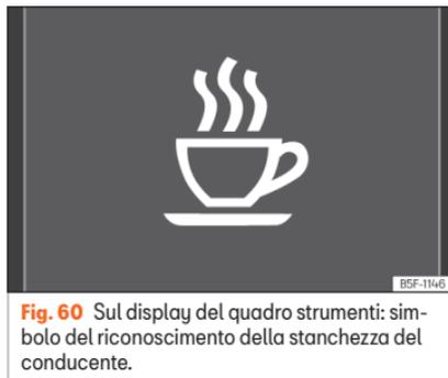
**Fig. 60** Sul display del quadro strumenti: simbolo del riconoscimento della stanchezza del conducente.
