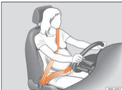
**Fig. 13** Posizione del nastro della cintura di sicurezza per donne in stato di gravidanza.
