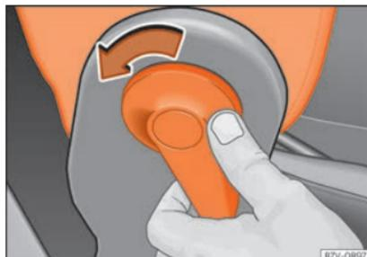
**Fig. 118** Sbloccare lo schienale ribaltabile del sedile del passeggero.
