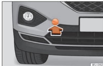
**Fig. 48** Sul lato destro del paraurti anteriore: estrarre il coperchio.
