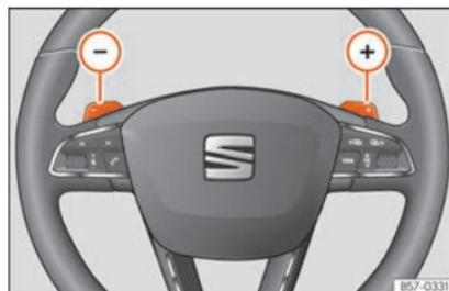
**Fig. 247** Volante: leve per il cambio automatico.
