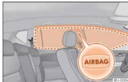
Fig. 23 Posizione degli airbag per la testa.
