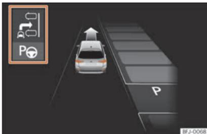
**Fig. 282** Sul display del quadro strumenti: visualizzazione dell'assistente di parcheggio con visualizzazione ridotta.
