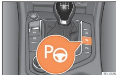
**Fig. 281** Nella parte superiore della console centrale: tasto per inserire l'assistente di parcheggio.
