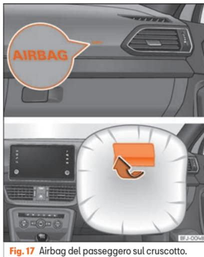
**Fig. 17** Airbag del passeggero sul cruscotto.
