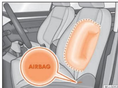
**Fig. 22** Airbag laterale all'interno del sedile del conducente.
