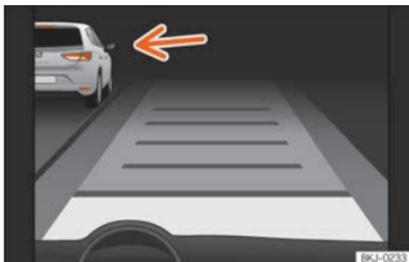
**Fig. 267** Sul display del quadro strumenti: ACC attivo, veicolo rilevato sulla sinistra
