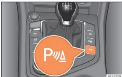
**Fig. 288** Console centrale: tasto dell'assistenza per il parcheggio.
