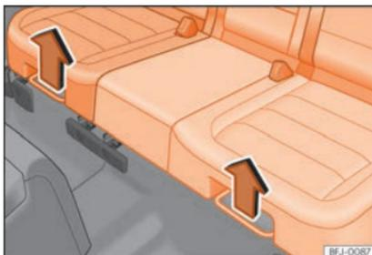
**Fig. 109** Sotto il divano del sedile posteriore: leve di regolazione.
