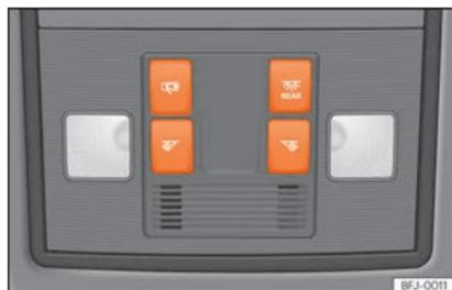
**Fig. 100** Dettaglio del rivestimento del tetto: illuminazione anteriore dell'abitacolo.
