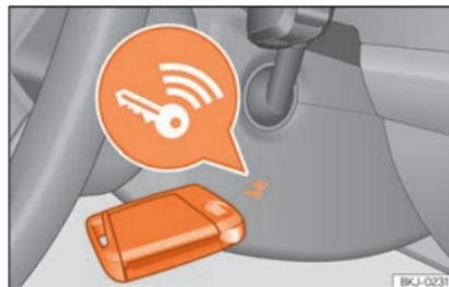
**Fig. 241** A destra del piantone dello sterzo: avviamento di emergenza.
