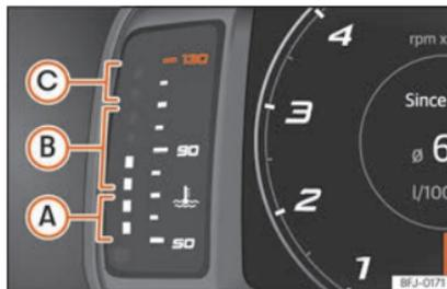
Fig. 63 Quadro strumenti digitale: indicatore della temperatura del liquido di raffreddamento.
