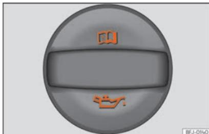
**Fig. 314** Vano motore: tappo del bocchettone di rifornimento dell'olio motore.
