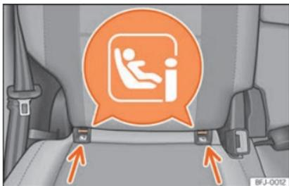
**Fig. 28** Sedili laterali della seconda fila: occhielli di fissaggio ISOFIX/iSize.
