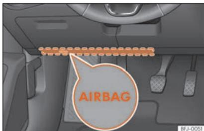
**Fig. 20** Sul lato conducente: posizione dell'airbag per le ginocchia.
