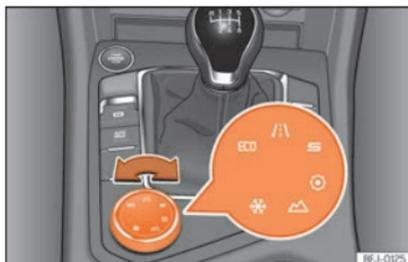
**Fig. 249** Console centrale: Manopola di comando (Driving Experience button).
