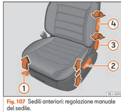
**Fig. 107** Sedili anteriori: regolazione manuale del sedile.
