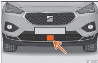
**Fig. 264** Sul paraurti anteriore: sensore radar.
