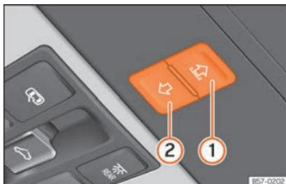
**Fig. 91** Nel rivestimento interno del tettuccio: tasti della tendina parasole.
