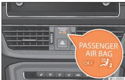
**Fig. 19** Cruscotto: spia della disattivazione dell'airbag del passeggero anteriore.
