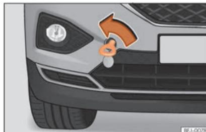
**Fig. 49** Sul lato destro del paraurti anteriore: occhiello di traino avvitato.
