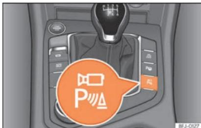
**Fig. 296** Console centrale: tasto per attivare/disattivare manualmente il sistema di visione periferica quando è abbinato all'assistente di parcheggio.
