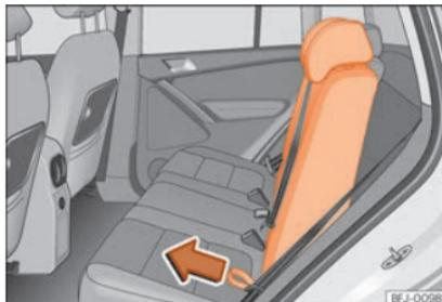
**Fig. 119** Ribaltamento e sollevamento dello schienale del sedile posteriore.
