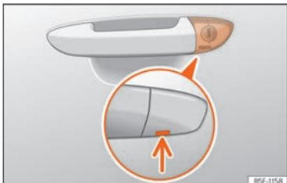
**Fig. 80** Maniglia della porta del conducente: serratura di chiusura non visibile.
