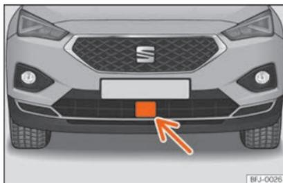
**Fig. 258** Sul paraurti anteriore: sensore radar.
