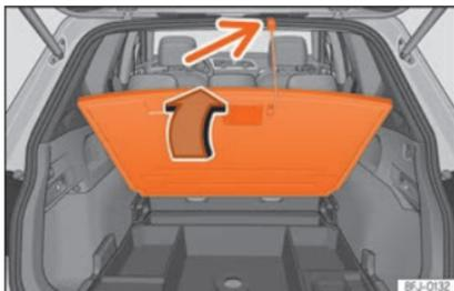
**Fig. 128** Nel bagagliaio: sollevare il piano di carico del bagagliaio.
