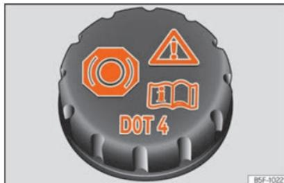
**Fig. 317** Vano motore: tappo del serbatoio del liquido dei freni.
