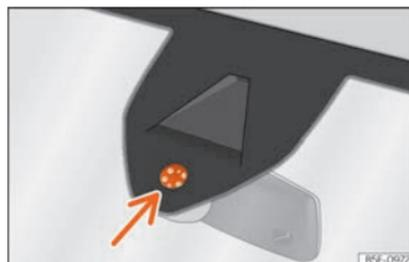
Fig. 103 Superficie sensibile del sensore pioggia.
