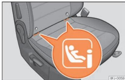
**Fig. 29** Sedile passeggero anteriore: occhielli di fissaggio del sistema ISOFIX.
