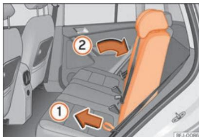
**Fig. 110** Regolazione dello schienale del sedile posteriore.
