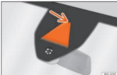
**Fig. 270** Nel parabrezza: area del campo visivo della telecamera del dispositivo di assistenza per il mantenimento della corsia.
