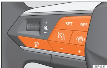
**Fig. 6** Sul volante multifunzione: tasti di comando dell'ACC
