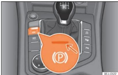
**Fig. 278** Nella parte inferiore della console centrale: tasto del freno di stazionamento elettronico.
