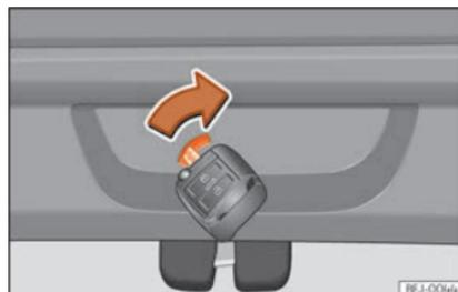
**Fig. 88** Particolare del bagagliaio: sblocco di emergenza.
