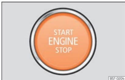
**Fig. 240** Nella parte inferiore della console centrale: pulsante di avviamento.
