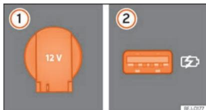
**Fig. 150** ① Presa elettrica da 12 volt. ② Presa di corrente USB nella parte posteriore della console centrale.
