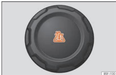
**Fig. 316** Vano motore: tappo del serbatoio di compensazione del liquido di raffreddamento.
