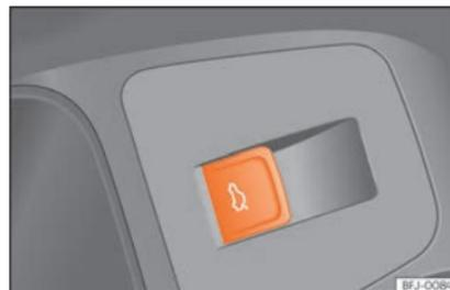
**Fig. 86** Sulla porta del conducente: tasto per aprire e chiudere il portellone posteriore.
