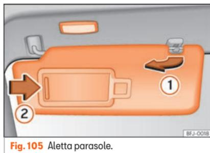
**Fig. 105** Aletta parasole.**Possibilità di regolazione delle alette parasole per il conducente e il passeggero**
