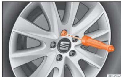
**Fig. 42** Cambio di una ruota: allentare i bulloni della ruota con l'impugnatura del cacciavite.
