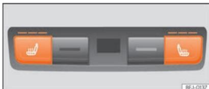
**Fig. 158** Nella parte posteriore della console centrale: comandi per il riscaldamento dei sedili posteriori.
