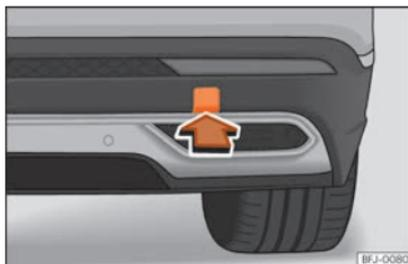
Fig. 50 Sul lato destro del paraurti posteriore: estrarre il coperchio.
