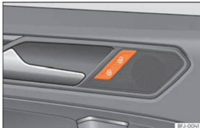
**Fig. 76** Porta del conducente: interruttore della chiusura centralizzata.
