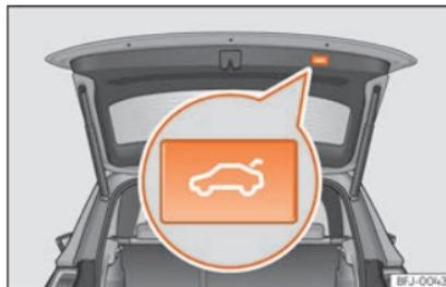
**Fig. 85** Portellone posteriore: tasto per chiudere il portellone.
