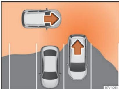
**Fig. 277** Rappresentazione schematica dell'assistente di uscita dal parcheggio: zona vigilata attorno al veicolo che sta uscendo dal parcheggio.
