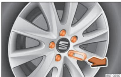
Fig. 36 Ruota: viti della ruota con tappi.
