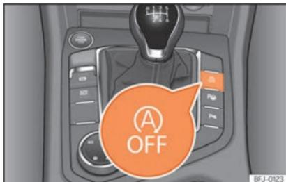
**Fig. 243** Console centrale: tasto del sistema Start/Stop.
