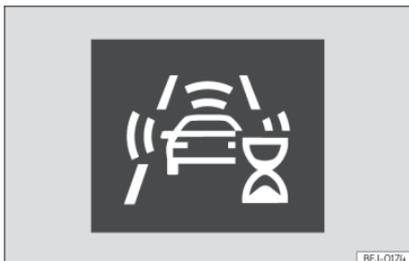
**Fig. 260** Sul display del quadro strumenti: indicazione dell'autocalibrazione iniziale del sistema.
