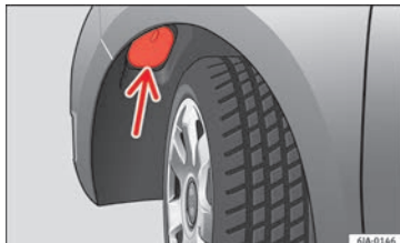
Fig. 92 Înlocuirea becurilor pentru fază scurtă: pasajul de roată.
