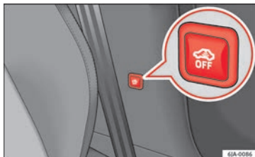
Fig. 127 Butonul pentru monitorizarea habitaculului automobilului și a sistemului de protecție la tractare.
