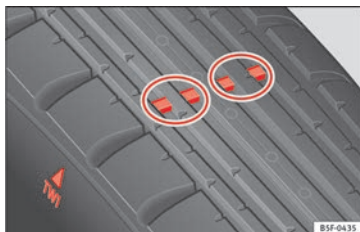
Fig. 212 Vedere din lateral a pneurilor cu indicatorii de uzură a suprafeței de rulare.
