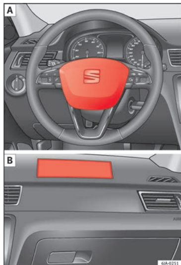
Fig. 15 Airbagul pentru șofer, montat în volan, și airbagul pentru pasagerul față, montat în planșa de bord
